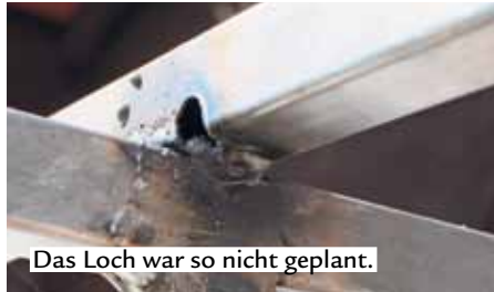
Widerstand ist zwecklos: Bei 100 Ampere wird auch Stahl ganz weich.
