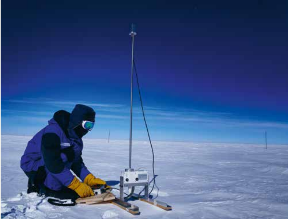
Tägliche SnowMicroPen Schneehärtemessung auf der Versuchsfläche, um die Schneemetamorphose unter den natürlichen Bedingungen während des antarktischen Sommers mitzuverfolgen.
